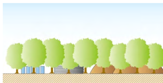
植栽や塀等で遮へいすることにより、 積み上げた箇所を見えづらくした例
