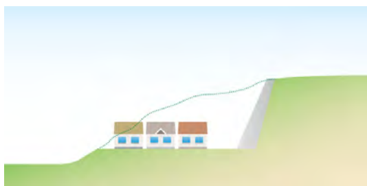
勾配が急な法面により、緑化ができない例
