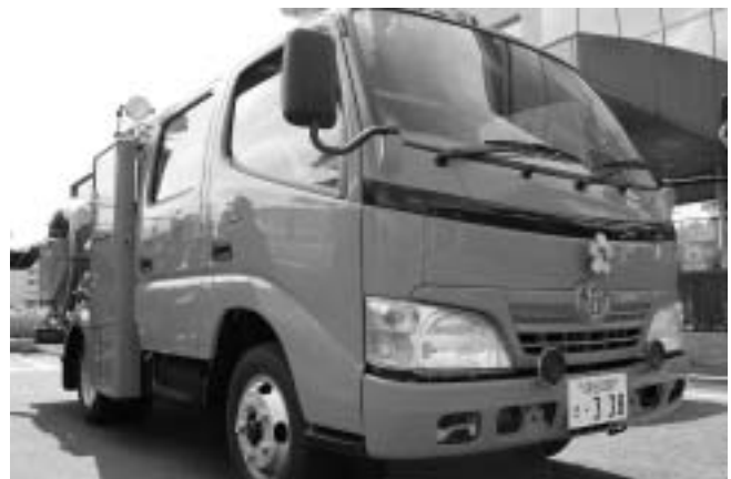
井之内岡・六区に導入された小型動力ポンプ付積載車(水槽付)
