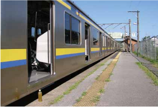
電車とホームの段差 (日向駅)
